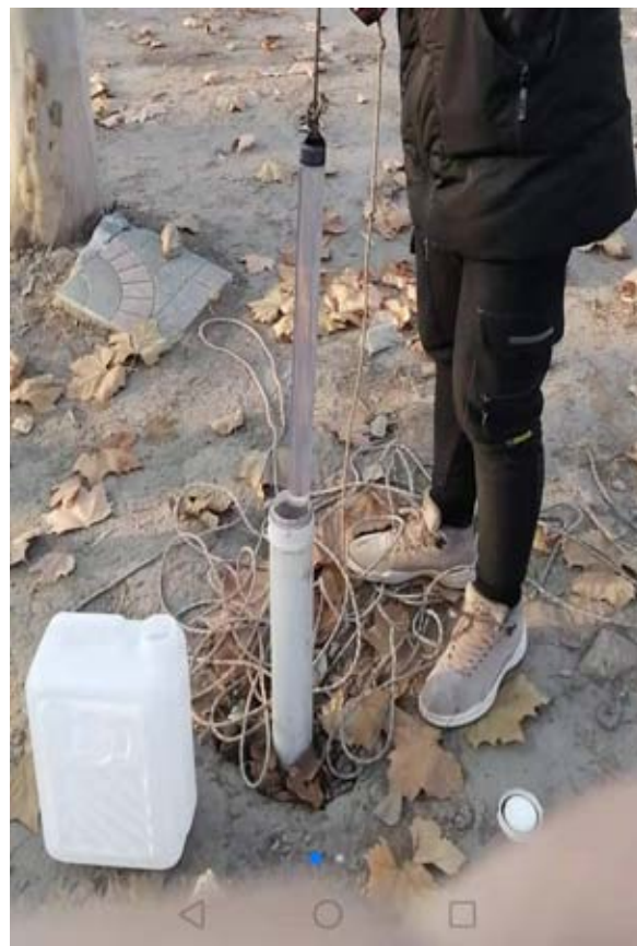
图 5.3-1 地下水采样照片
