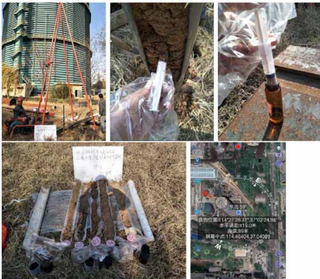
S9-1 (3/12 万煤气柜水封槽附近) 现场采样照片:
