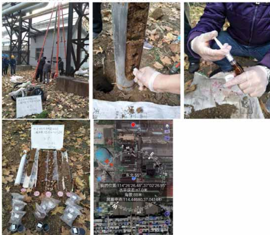
S6-7（四高线废水收集池北侧）现场采样照片：
