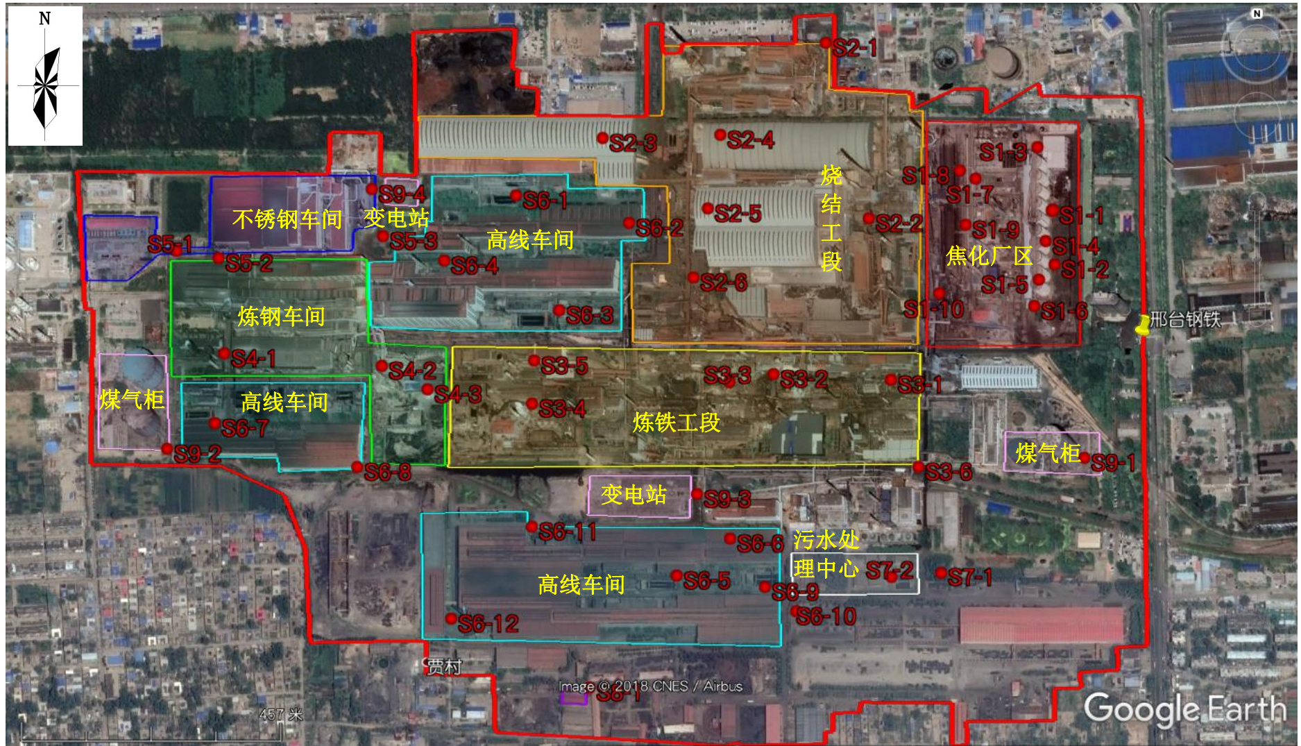
图 5.2-7 邢钢厂区土壤采样布点图（全貌）
